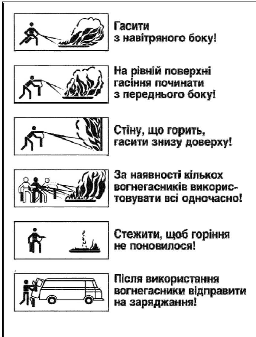
Мал. 4.7. Рекомендації щодо застосування порошкових вогнегасників.
