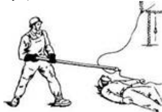
Мал.5.2. Звільнення потерпілого від дії струму в електроустановках напругою понад 1000 В ізолюючою штангою
